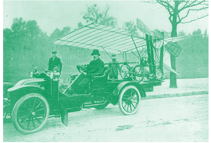
1907. Uno de sus más exitosos inventos fue el aeroplano Demoiselle, de muy pequeño tamaño y plegable para transportarlo en su coche. A la izda. a los mandos del aeroplano y a la dcha. transportándolo. (Arch. Rescate).
